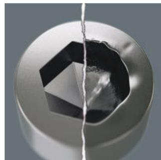
既有的内六角螺丝工具存在一个问题，由于从工具传递外力到螺丝的接触面很窄，导致螺丝头可能会损坏，通常是凹处被磨圆。Hex-Plus六角增强型工具有较大的接触面，它从凹槽的平面处驱动螺丝，而不是从角面，可防止这种损坏。Hex-Plus工具适合每一个标准内六角螺丝！
