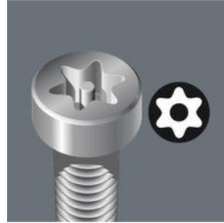
带安全销的TORX®工具可防止安全螺丝被随意拆卸。这些防盗螺丝头有伸出到齿廓的安全销，普通的TORX®工具无法使用，而TORX® B0工具的孔可与其相匹配，从而拆卸安全螺丝。
