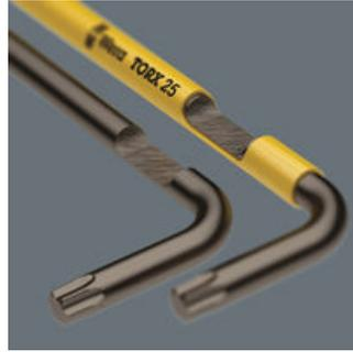
SPKL，保护手指！带热塑料护套的L型扳手（SPKL）用握持舒适的圆形材料制成，在低温环境下也能确保工作安全舒适。经过特殊的激光表面处理过的材质具有抗腐蚀性。颜色识别标识和印记方便找到需要的L型扳手。
