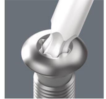
球头驱动意味着工具轴可以绕着螺丝旋转，因而可以在狭窄区域带角度地进行螺丝拆装。经常应用在内六角扳手球头上的几何形状现在也应用在维拉批头上。
