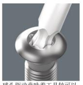
球头驱动意味着工具轴可以 绕着螺丝旋转,因而可以在 狭窄区域带角度地进行螺丝 拆装。经常应用在内六角扳 手球头上的几何形状现在也 应用在维拉批头上。
