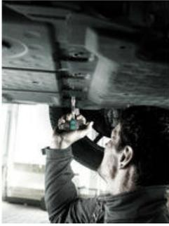
411 A RA T 型柄适用于 1/4" 套筒扳手嵌件。套筒扳手通过球牢固锁紧。
