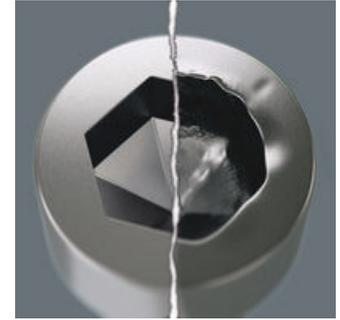
内六角螺丝存在一个问题, 由于从扳手头传递外力到螺丝的接触面很窄, 导致螺丝头可能会损坏, 通常是凹处被磨圆。Hex-Plus花形有较大的接触面, 可防止这种损坏。它从凹槽的平面处驱动螺丝, 而不是从角面, 因此和一般L型扳手相比增加了20%可以被传递的扭矩。并且Hex-Plus工具适合每一个标准内六角螺丝。
