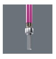
扳手长端上的球锁使得螺丝 能够被紧紧卡住,固持功能 则在只能单手操作的狭窄和 尴尬空间内特别有效。
