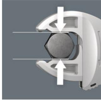
Joker 6006 双头扳手的平行、光滑钳口提供了座合应力，因此可以防止螺母或螺丝头钝化变形，这可能发生在通过棱角输送动力时。
