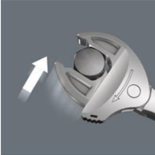
Joker 6006 双头扳手自动且持续地握住平行卡爪，覆盖了潜在工作范围内的所有尺寸。将工具连接到螺栓或螺丝上时，工具本身即可找到所需尺寸。
