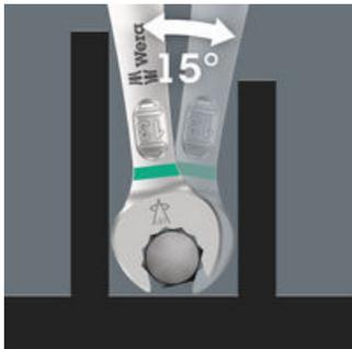
开口形状特殊的组合扳手- 翻转角为7.5°的开口和双六角形状- 将扳手沿纵轴重复转动 180°时, 其接触面随之扩大两倍。螺帽和螺栓均可在15°内完成装配。Joker 6003换向后可直接装配。
