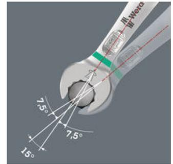
借助翻转角为 7.5°的开口和双六角几何形状, 当扳手用法恰当时 (准备—紧固—旋转—再度准备—紧固—旋转), 可拧动摆动幅度不超过 30°的螺丝。
