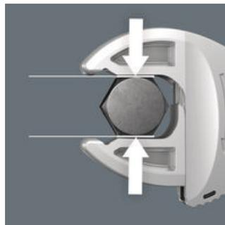
Joker 6004平行的光滑颚口因其表面压力, 能避免在传输扭力时螺帽和螺栓棱角因磨损而变形。
