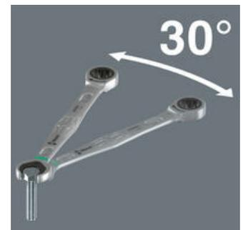
尤其是在狭小空间内, 传统的60° 回转角扳手必须翻来翻去才能紧固或松开螺栓或者螺帽, 而Joker独特的双六角设计使其回转角只有30°。加上直型颈部, 作业时不再需要翻转扳手。在传统的开口扳手无法使用的狭小空间内, Joker可以轻松紧固或松动螺栓和螺母。即使是在用螺栓连接管道时, Joker的限位挡块和极小回转角的完美配合也能让您有效地工作。
