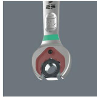
Joker系列的固定功能意味着螺栓和螺帽能被扳手头固定并轻松定位。因为采用了创新的特殊挡块来固定紧固件，它可快速、安全地进行紧固，从而避免浪费时间去寻找掉落的螺栓和螺帽！螺栓或螺帽定位好后，就可以快速地进行紧固，而无需使用任何额外的工具。
