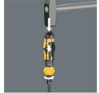
当冲击扳手功能开启时, 锤击冲击脉冲转换为旋转运动, 松动扭矩高达25 Nm。通过磅推力刀杆进行无损耗的功率传输。
