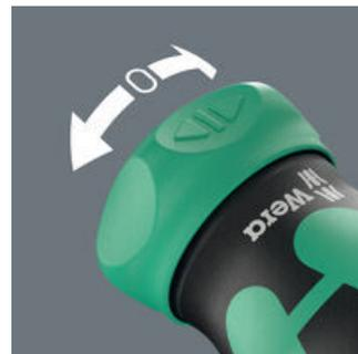
棘轮机构的直观切换。顺时针转动开关为顺时针旋紧；逆时针转动为逆时针旋紧。使用位置0停用棘轮机构以进行精确作业。
