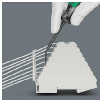
接线盒通过机械方式固持电线末端。拉力弹簧端子通过弹簧施加固持所需的作用力。为了插入电线末端，必须利用工具将弹簧打开。Wera 特殊驱动工具可操作拉力弹簧端子 - 即使在开关柜等空间狭小的区域也能够轻松操作。使用弯曲刀杆可以操作直刀杆无法触及的弹簧端子。
