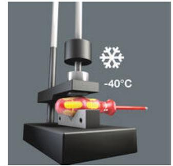
在-40° C下进行冲击韧性测试，以确保工具在极端环境下也能安全工作。
