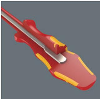
维拉Kraftform手柄由具有不同属性的多种材料组成。手柄核心部分为耐磨的塑料, 即使施加巨大的外力, 仍可牢牢抓住刀杆。彩色软质区由柔软材料制成, 具有更大的摩擦阻力, 用于高扭矩的传递。坚硬表面的黑色区域可防止手粘在手柄上, 便于更快速调整握持位置。
