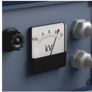
按照IEC 60900的标准, 每件工具都必须通过10,000伏的绝缘性能测试, 保证其在1,000伏的环境下能安全工作。
