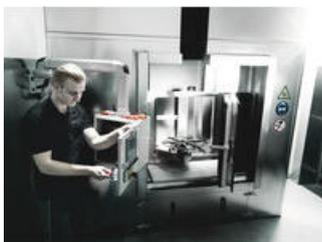
按照IEC 60900的标准，每件工具都必须通过10,000伏的绝缘性能测试，保证其在1,000伏的环境下能安全工作。
