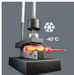
在-40°C下进行冲击韧性测试，以确保工具在极端环境下也能安全工作。
