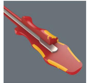
维拉Kraftform手柄由具有不同属性的多种材料组成。手柄核心部分为耐磨的塑料, 即使施加巨大的外力, 仍可牢牢抓住刀杆。彩色软质区由柔软材料制成, 具有更大的摩擦阻力, 用于高扭矩的传递。坚硬表面的黑色区域可防止手粘在手柄上, 便于更快速调整握持位置。
