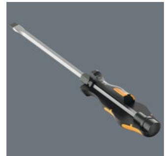
对于不仅需要旋拧的作业而言，凿子能提供解决方案。用于拧紧、敲击并松动卡死的螺丝或软管夹。采用集成式冲击螺帽，以延长使用寿命，并降低碎裂风险。采用优质材料制成的磅推力六角刀杆，即使在锤击时也能实现无损高力度传输。坚固韧性强的回火材料防止刀杆分裂或破碎。将开口扳手或环形扳手连接到一体式六角垫板，可以传递更多扭矩。
