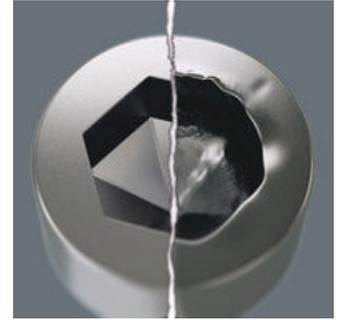
既有的内六角螺丝工具存在一个问题，由于从工具传递外力到螺丝的接触面很窄，导致螺丝头可能会损坏，通常是凹处被磨圆。Hex-Plus 六角增强型工具有较大的接触面，它从凹槽的平面处驱动螺丝，而不是从角面，可防止这种损坏。Hex-Plus 工具适合每一个标准内六角螺丝！
