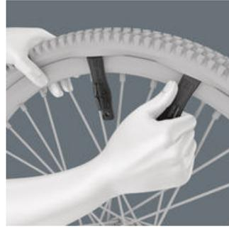
配玻璃纤维加固塑料轮胎千斤顶, 轮胎可以安全脱离轮辋而不损坏轮辋。凭借轮胎千斤顶, 轮胎可以安全脱离轮辋, 钩入辐条, 随后用第二个轮胎千斤顶拉出轮胎。两个轮胎千斤顶可以连接在一起, 不会单独丢失。
