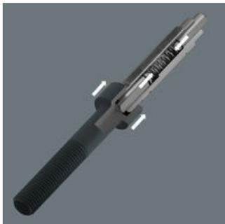
4 个螺丝尺寸可以使用 4 合 1 批头 9506 和 9507 进行操作。用于四种尺寸内六角螺丝 (3.0、4.0、5.0、6.0) 的 4 合 1 位 9506, 用于三种尺寸内六角螺丝 (2.5、5.0、6.0) 和一种尺寸 TORX® 梅花螺丝 (TX 25) 的 4 合 1 批头 9507。为了使用较大的型材, 在旋拧时不断按压弹簧张力, 可缩入较小花形, 并使用较大花形。
