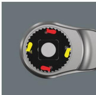
Zyklop Metal 推杆式: 双齿结构使其坚固的38齿也能得到和76细齿一样的4.7°回转角。
