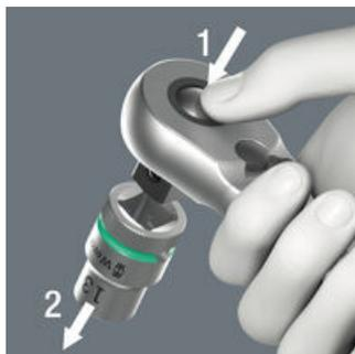
球锁能够使套筒和配件之间的连接更稳固, 增加操作时的安全性。只需轻按按钮即可解除连接, 更换工具。
