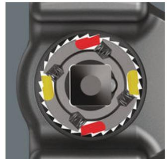
双齿结构使其坚固的30齿也能得到和60细齿一样的6°回转角。
